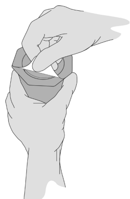
Рис. 8а. Отлепите наружную крышку
